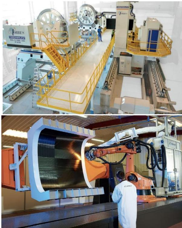
Figura 52. Colocação automatizada de fibras [35]: (a) exemplo de equipamento comercial (MTorres Machine Company, Espanha); (b) AFP robótico em várias orientações (Coriolis Composites, França).
