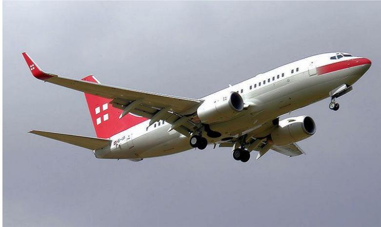
Figura 65. Boeing 737-700 com *winglets*.
