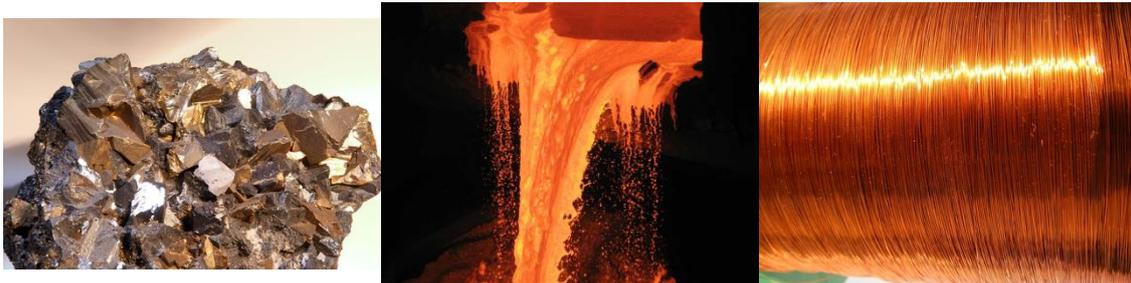
Figura 8. Do minério de cobre ao fio de cobre: (a) a calcopirite ( $\text{CuFeS}_2$ , com 34.5 %-Cu) é um dos vários minérios de cobre existentes na natureza; (b) pode ser refinado para obtenção de cobre metálico; (c) e o metal é depois enformado para obtenção da forma final desejada.
