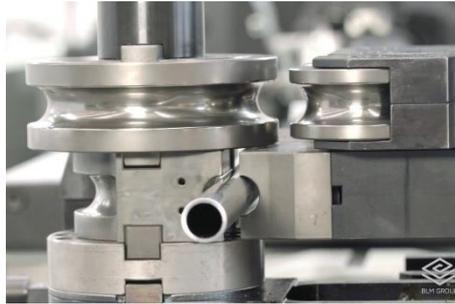
Figura 51. Dobragem de tubos de metal CNC.
