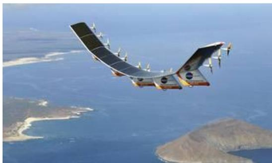
Figura 6. O gigante protótipo solar-elétrico Helios no seu voo de teste a energia solar [8].
