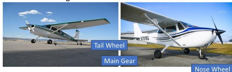
Figura 28. Trem de aterragem convencional (esquerda) e trem de triciclo (direita)
