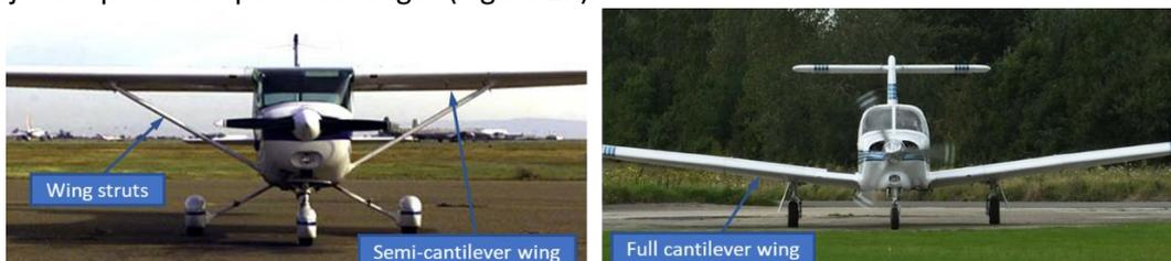
Figura 25. Asa semi-encastada (esquerda) e encastrada completa (direita)
